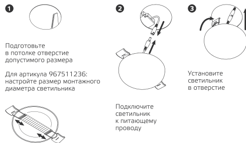
Рис. 2. Порядок монтажа
